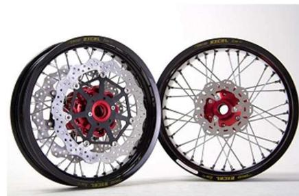
Überprüfung der Felge → Optische Kontrolle auf Risse in der Felge, sowie auch auf herausgebrochene Ecken, Beulen, tiefe Kerben oder verbogene Speichen. Speichen können auch mit der Klangprobe überprüft werden. Hierzu nimmt man z.B. einen Schraubenzieher und zieht diesen über die Speichen, es sollte ein gleichmäßiger und heller Klang ertönen. Falls einige Speichen locker wären, würde es hier sofort auffallen. Dies kann ein kundiger Fachmann schnell beheben und die Felge wieder in Stand setzen.
